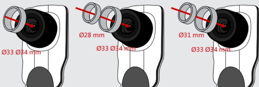
4. 请先将显微镜转接器安装在本机台的镜头上。
